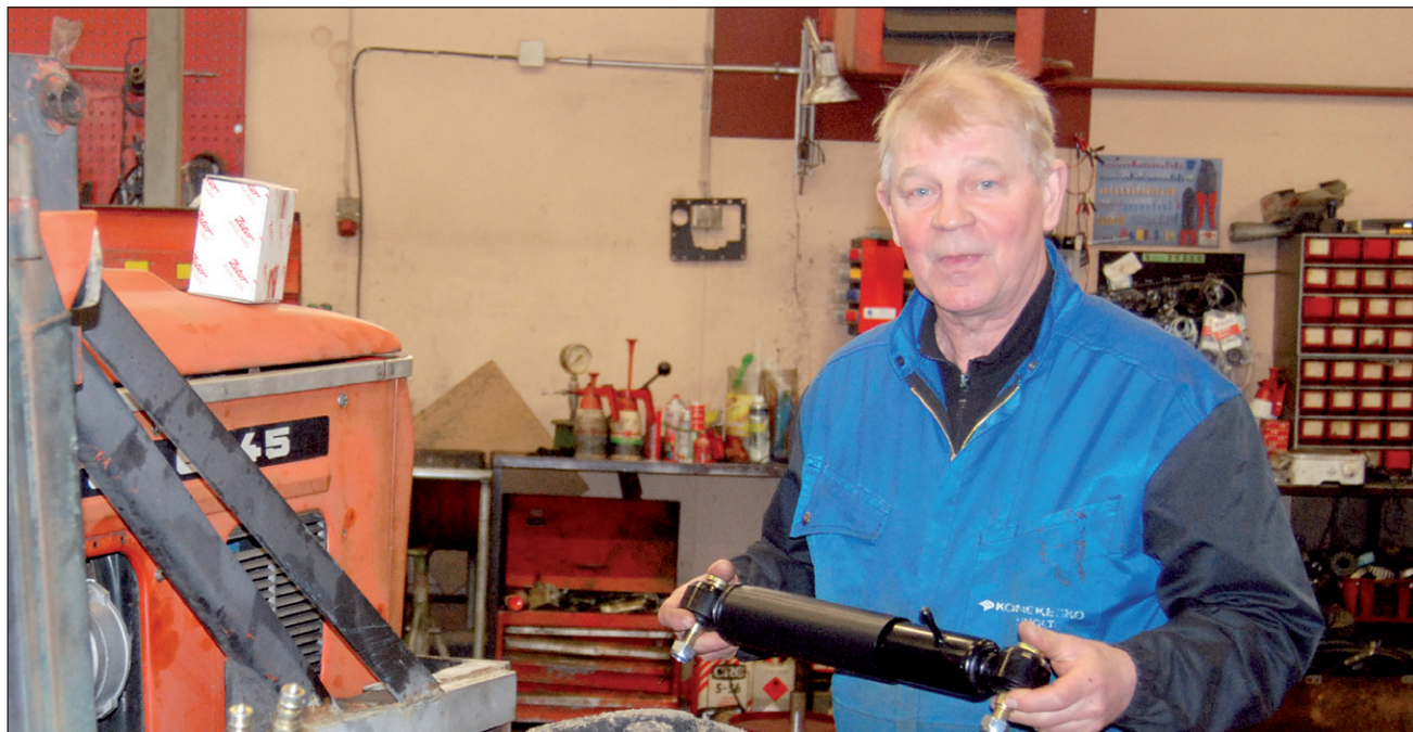
Tähän vanhaan Zetoriin Heikki Hautala oli asentamassa muun muassa ohjauksen iskunvaimenninta, jotta traktori muuttuu miellyttävämmäksi ja helpommaksi ajaa.
