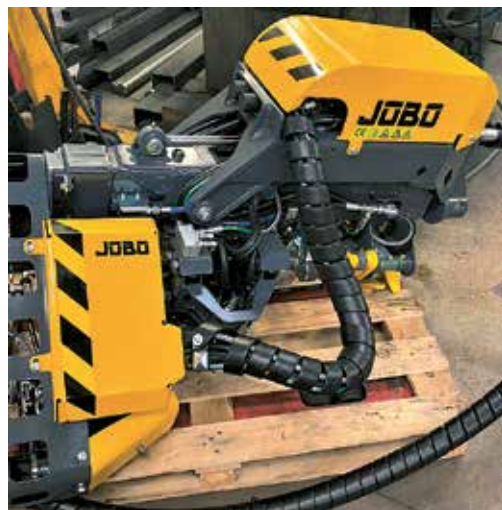
Ett färdigt skördaraggregat på väg till Sverige. Fälldiameteren är 30 centimeter, den lämpar sig bra för första gallring och den har både steg- och rullmatning.
