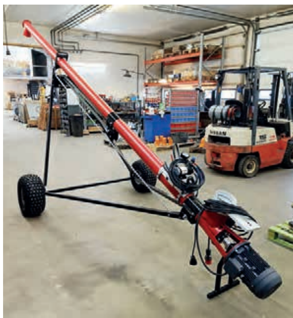
Viljanpeittauslaite ja ruuvikuljetin jalustalla varustettuna peittainruuvi.
