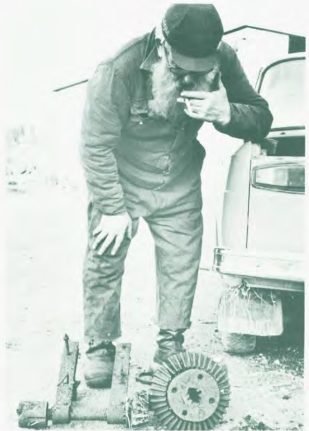
Siinä se on vanha jenkakone, jolla kierrettiin jenkaa Perttilän sillan kannatinrautojen päihin.
