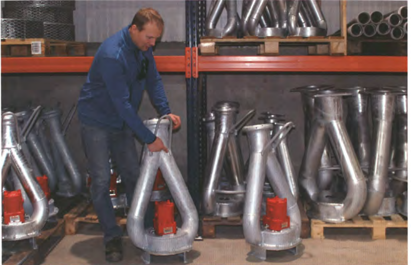
Tapio Mäki-Reini esittelee Reini-uppopumppuja: Pumppujen teho perustuu kahden poistoputken ja siipipyörän yhteistyöhön.
